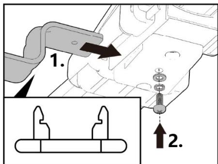
Auch der Fahrradträger muss für den Einsatz der Erweiterung für das dritte Fahrrad vorbereitet werden. Befestigen Sie die Aluminiumhalterungen an der oberen Schieberahmen des Fahrradträgers.
