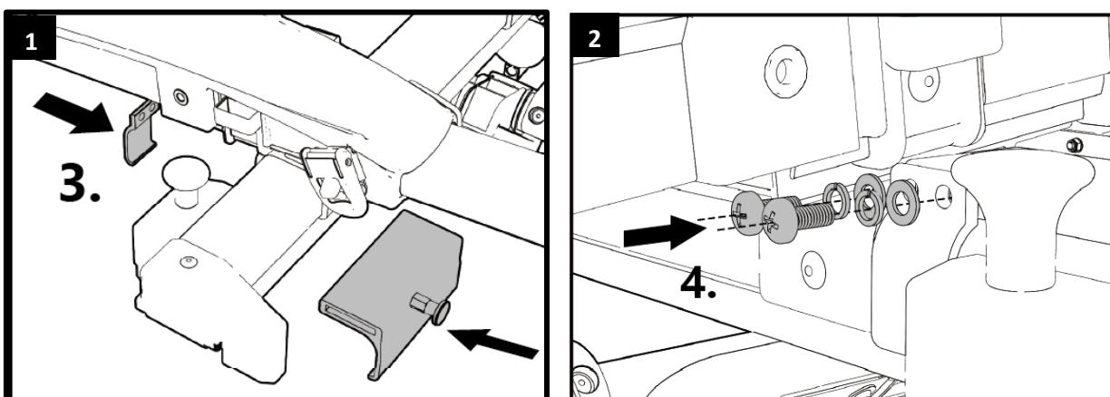
Na de montage kan de 3<sup>e</sup> fietsadapter op de fietsendrager geplaatst worden:
