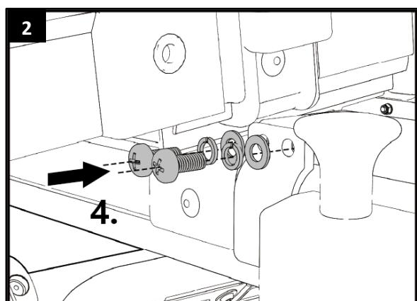
Après l'assemblage, le 3ième adaptateur de vélo peut être placé au porte-vélo: premièrement fixe le porte-vélo à l'attache remorque comme décrit dans les instructions d'utilisation de Enduro SD260.
