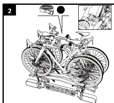
Befestigen Sie zum Schluss immer das Sicherheitsspannband!
