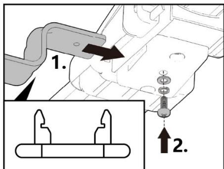
Aussi le porte-vélo doit être préparé un fois avant utiliser le 3ème adaptateur de vélo. Fixez les supports au support de roue du porte-vélo.
