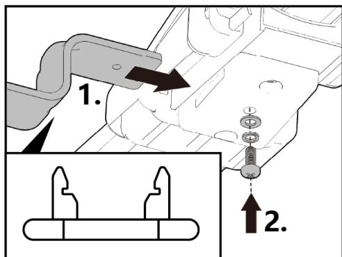
Ook de fietsendrager moet éénmalig voorbereid worden voor het gebruik van de 3<sup>e</sup> fietsadapter. Bevestig de houders aan het boven frame van de fietsendrager.
