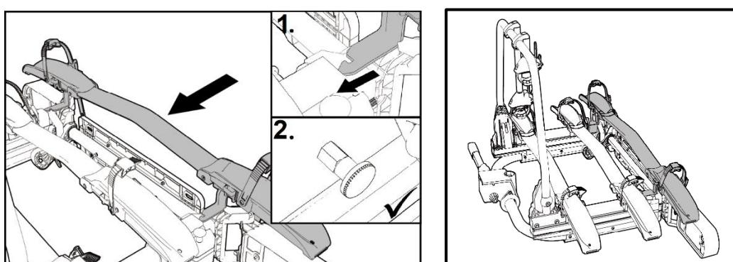
Setzen Sie dann die Erweiterung von hinten auf in die Aluminiumhalter (1) und prüfen Sie, ob die beiden Knöpfe gesichert sind (2).
